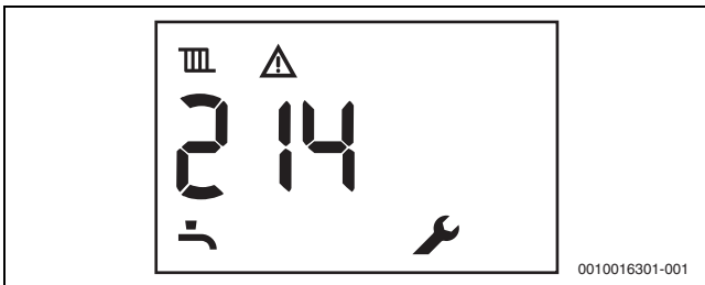
Afb. 6 Voorbeeld van een storingscode
