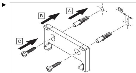
Montieren Sie den Gerätehalter in einer Höhe von ca. 1,50 m.
