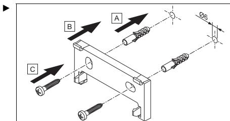
Montez le support de l'appareil à 1,50 m de haute environ.
