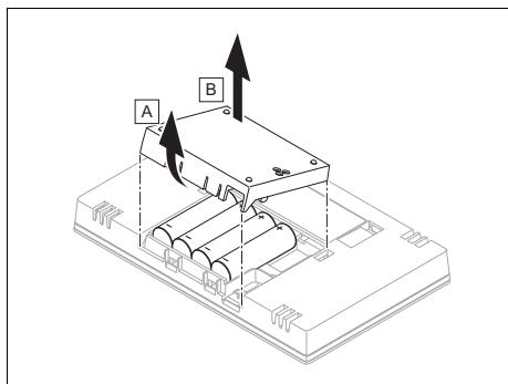
2. Öffnen Sie das Batteriefach.
