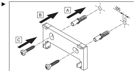
Montare il supporto dell'apparecchio a un'altezza di ca. 1,50 m.
