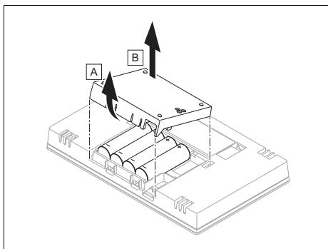
2. Öffnen Sie das Batteriefach.
