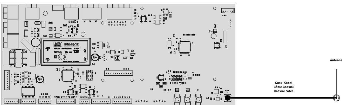
\* Voorbeeld van een Duco printplaat. De Antenne bevindt zich bij elke printplaat op dezelfde plaats.
