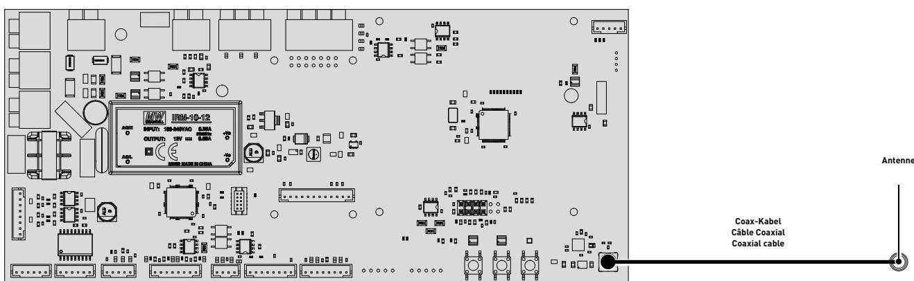
\* Voorbeeld van een Duco printplaat. De Antenne bevindt zich bij elke printplaat op dezelfde plaats.
